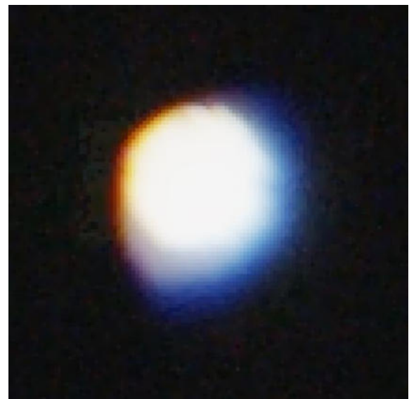
Figura 65. Aberración cromática lateral del 100 mm. Detalle ampliado \times 1500 de una perforación lateral de la carta Via Stellae , con ligero incremento de contraste y la saturación para evidenciar la separación de los canales.
