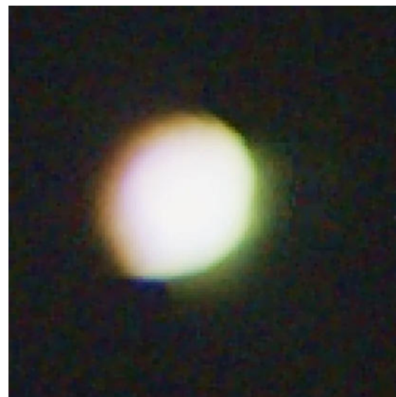
Figura 14. Aberración cromática lateral del 35 mm. Detalle ampliado \times 1500 de una perforación lateral de la carta Via Stellae, con ligero incremento de contraste y la saturación para evidenciar la separación de los canales.
