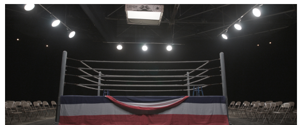
Uno de los diseños, en el centro caja de luz con tres Skypanel60 y seda. En los laterales plafones con lámparas de tungsteno 1000w a regulación y con difusión.
