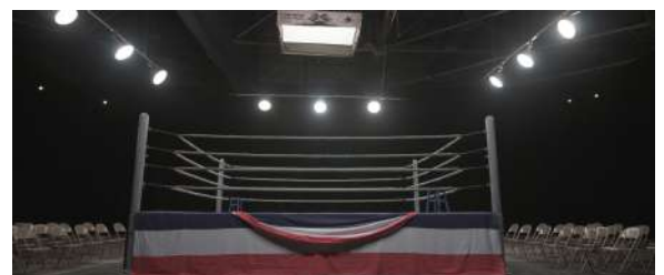
L'une des conceptions comprenait une boîte à lumière au centre, avec trois Skypanel 60 et de la soie. Sur les côtés, il y avait des plafonniers équipés de lampes au tungstène de 1000 W, avec gradation et diffusion.
